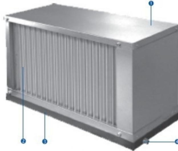
1 корпус, 2 пластины каплеуловителя, 3 ванна для конденсата, 4 система отвода конденсата
